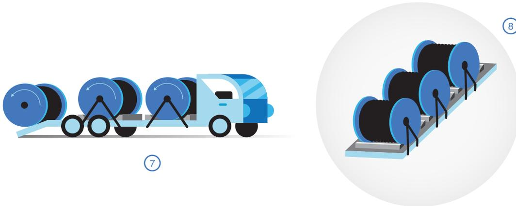
d) No se debe lanzar el carrete desde el medio de transporte al suelo. De no disponer de grúas o montacargas para bajar los carretes del camión, se puede utilizar una rampa (figura 7).
